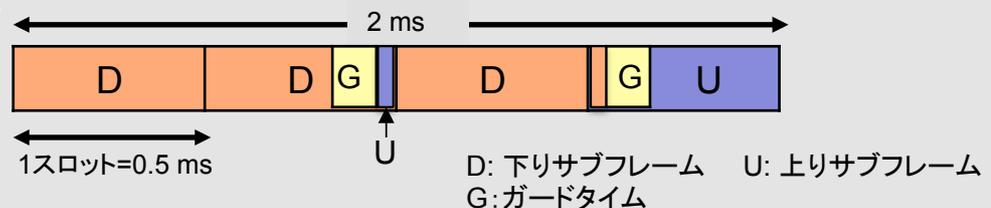
【参考】 LTEで一般的なTDDフレーム構成 (1フレーム=10ms)
