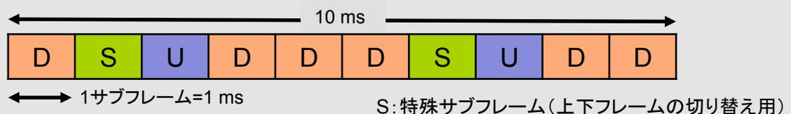
1フレームを2msに短縮することで、U/D間の最大遅延を1ms以下にできる。
